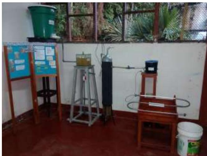
*Figura 1. Sistema integrado del Reactor Anaeróbico de Flujo Ascendente con Lecho Fijo y Fotocatalizador Heterogéneo.*
