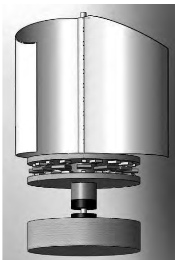
Figura 1. Esquema general del aerogenerador
