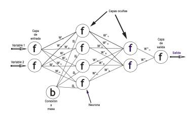
Figura 1: Esquema de una red neuronal tipo perceptrón
